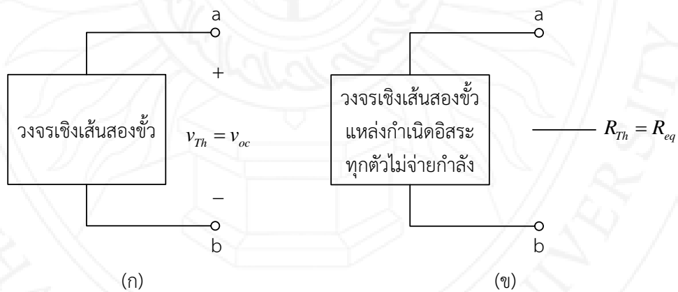
รูปที่ 4.22 แรงดันและความต้านทานสมมูลเทเวนนินระหว่างขั้ว a-b
