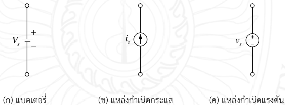
รูปที่ 1.17 สัญลักษณ์แหล่งกำเนิดอิสระชนิดกระแสตรง
