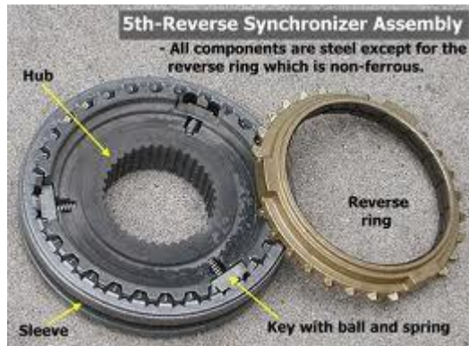
รูปที่ 3.7 แสดงส่วนประกอบของชุดซิงโครไนเซอร์
