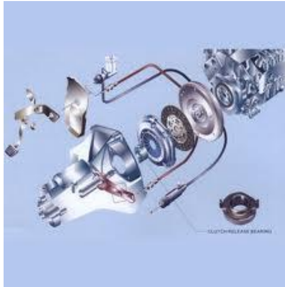
รูปที่ 2.4 แสดงส่วนประกอบของชุดกดแผ่นคลัตช์
