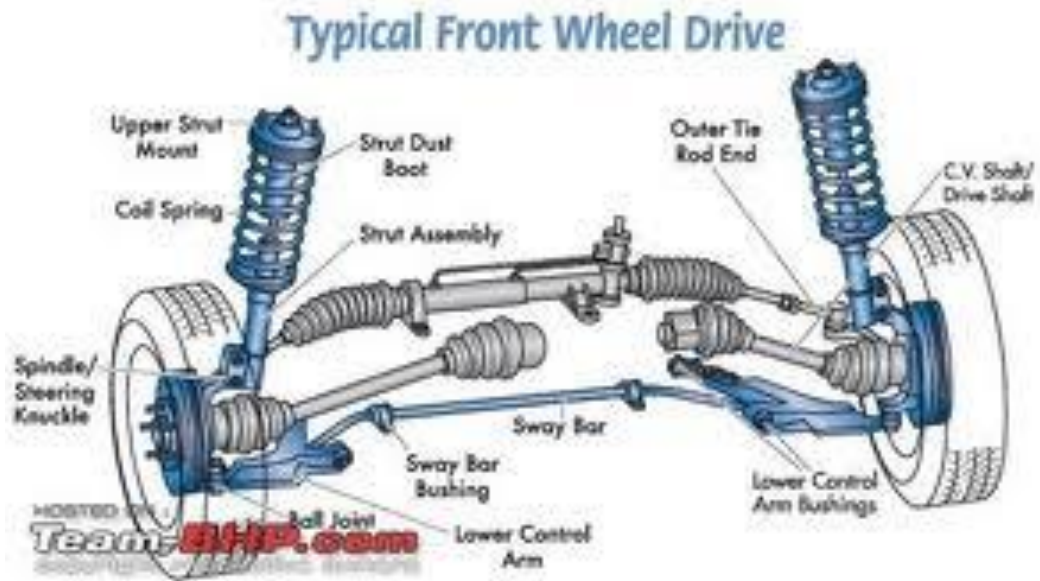
รูปที่ 1.3 แสดงการทำงานของระบบรถขับเคลื่อนล้อหน้า
